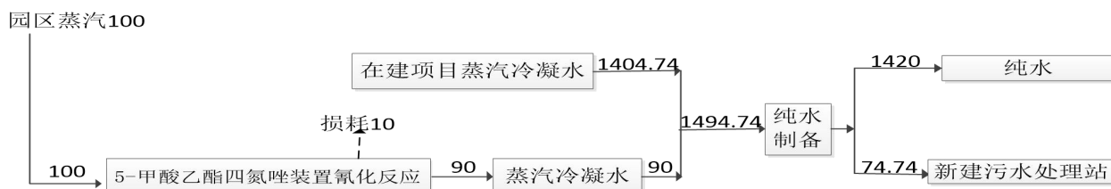
图 4.2-7 拟建项目蒸汽平衡图 t/a
