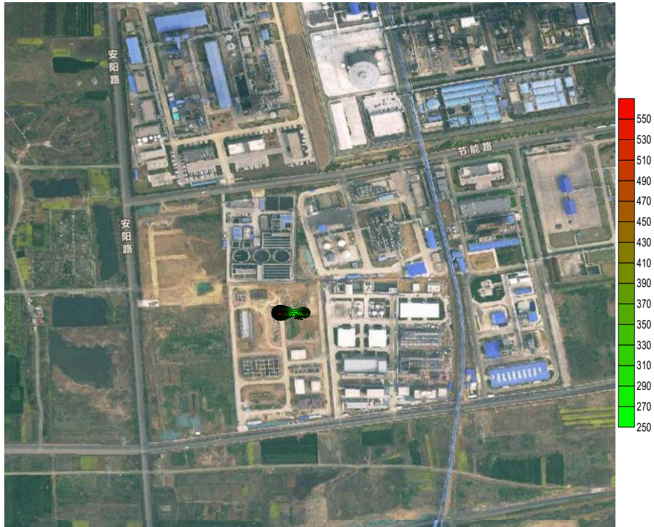
图 7.4-6 连续泄漏 100 天氯化物污染范围示意图
