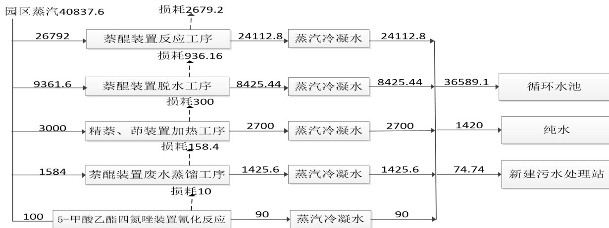
图 4.2-8 拟建项目建成后全厂总蒸汽平衡图 t/a
