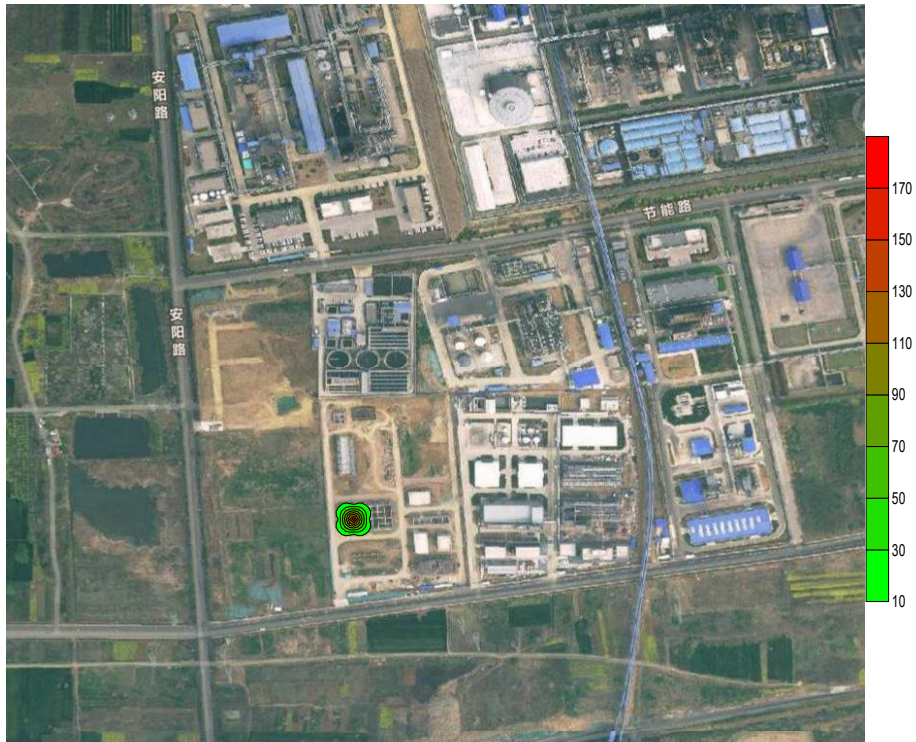
图 7.4-12 瞬时泄漏 100 天氯化物污染范围示意图
