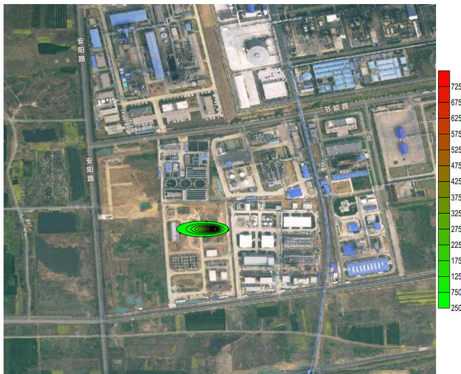
图 7.4-8 连续泄漏 7300 天氯化物污染范围示意图
