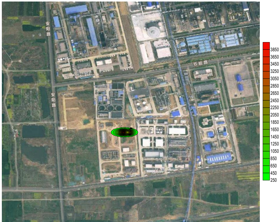
图 7.4-7 连续泄漏 1000 天氯化物污染范围示意图
