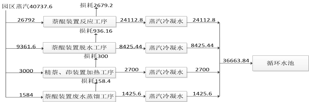
图 3.2-5 拟建项目蒸汽平衡图 (t/a)
