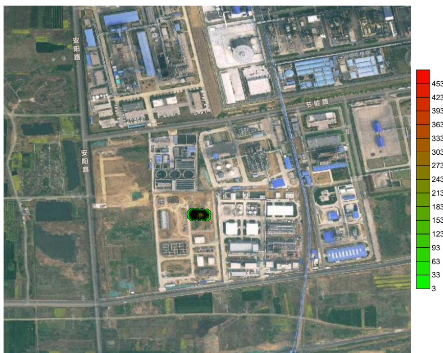
图 7.4-3 连续泄漏 100 天 COD 污染范围示意图
