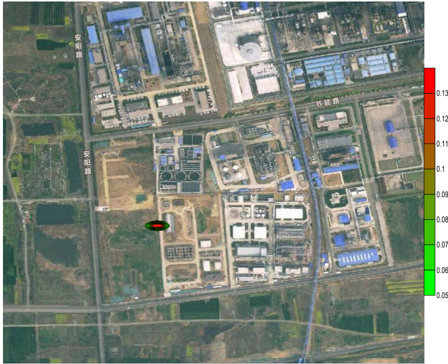
图 7.4-16 瞬时泄漏 1000 天氰化物污染范围示意图
