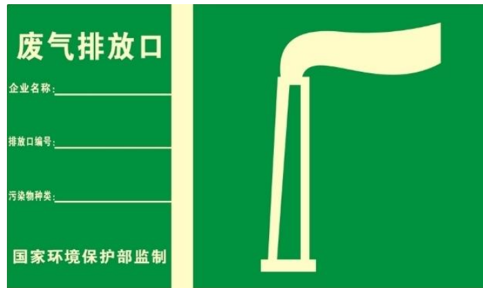
图 8.2-3 废气排放口标志牌样式
