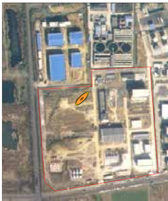
图 6.4-6 瞬时泄露情况下苯污染范围图(1000d)
