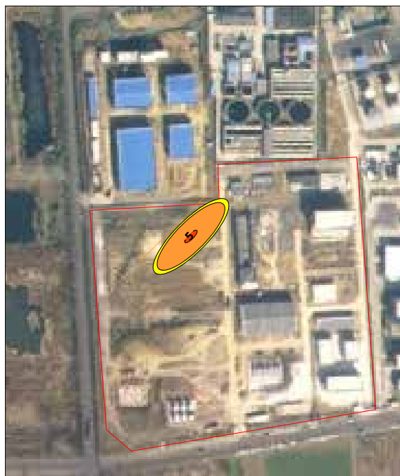
图 6.4-6 瞬时泄露情况下苯污染范围图(1000d)
