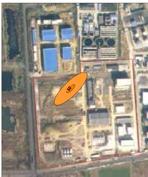
图 6.4-4 瞬时泄露情况下 PH 污染范围图(1000d)
