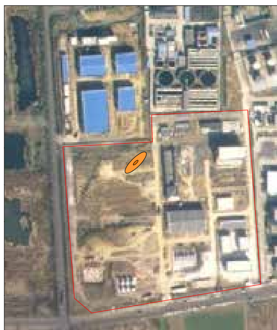
图 6.4-3 瞬时泄露情况下 PH 污染范围图(100d)
