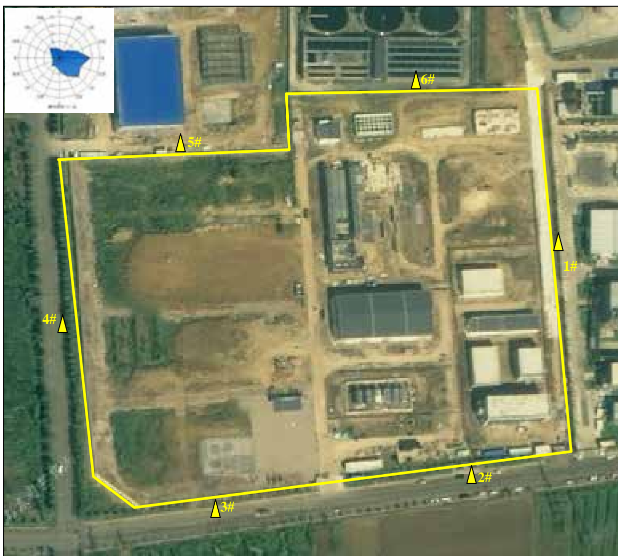
图 7-1 拟建项目噪声监测布点图(1:2000)
