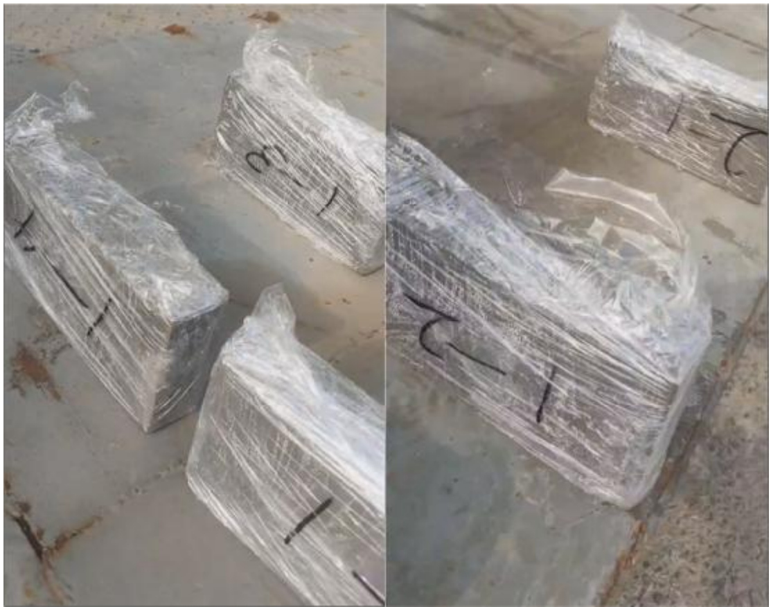
图 1 拟建项目固废各配比下试制样品图
