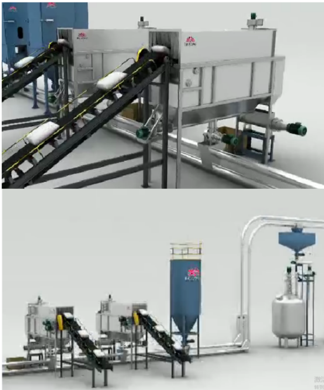
图 2.8-2 无尘上料系统示意图
