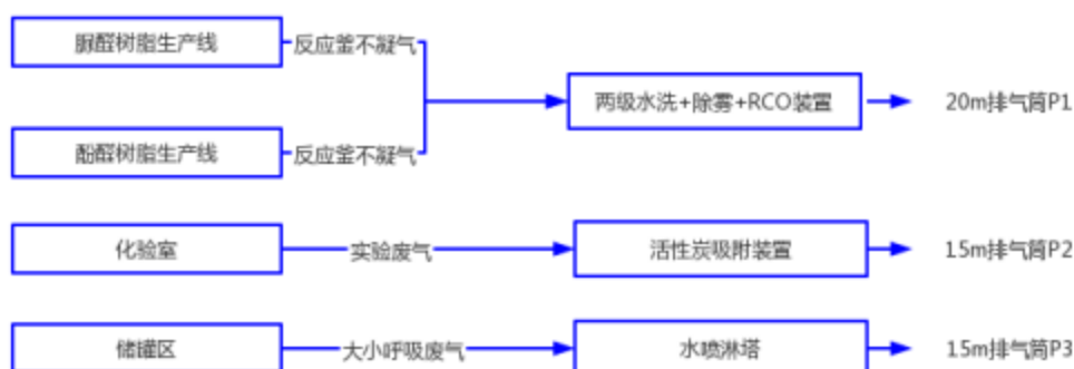
图 2.8-1 拟建项目有组织废气收集处理路线示意图
