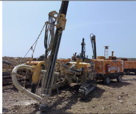
矿山 4 台转孔机已配置除尘器
