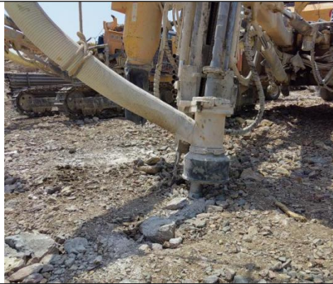
矿山 4 台转孔机已配置除尘器
