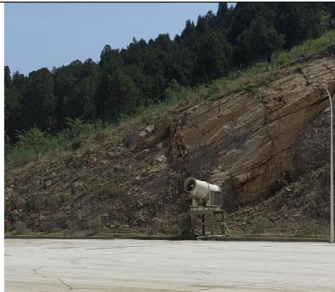
矿区道路硬化并设置雾炮机及颗粒物监测仪
