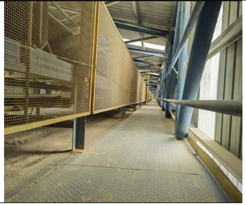
石灰石由封闭皮带廊道运输进厂
