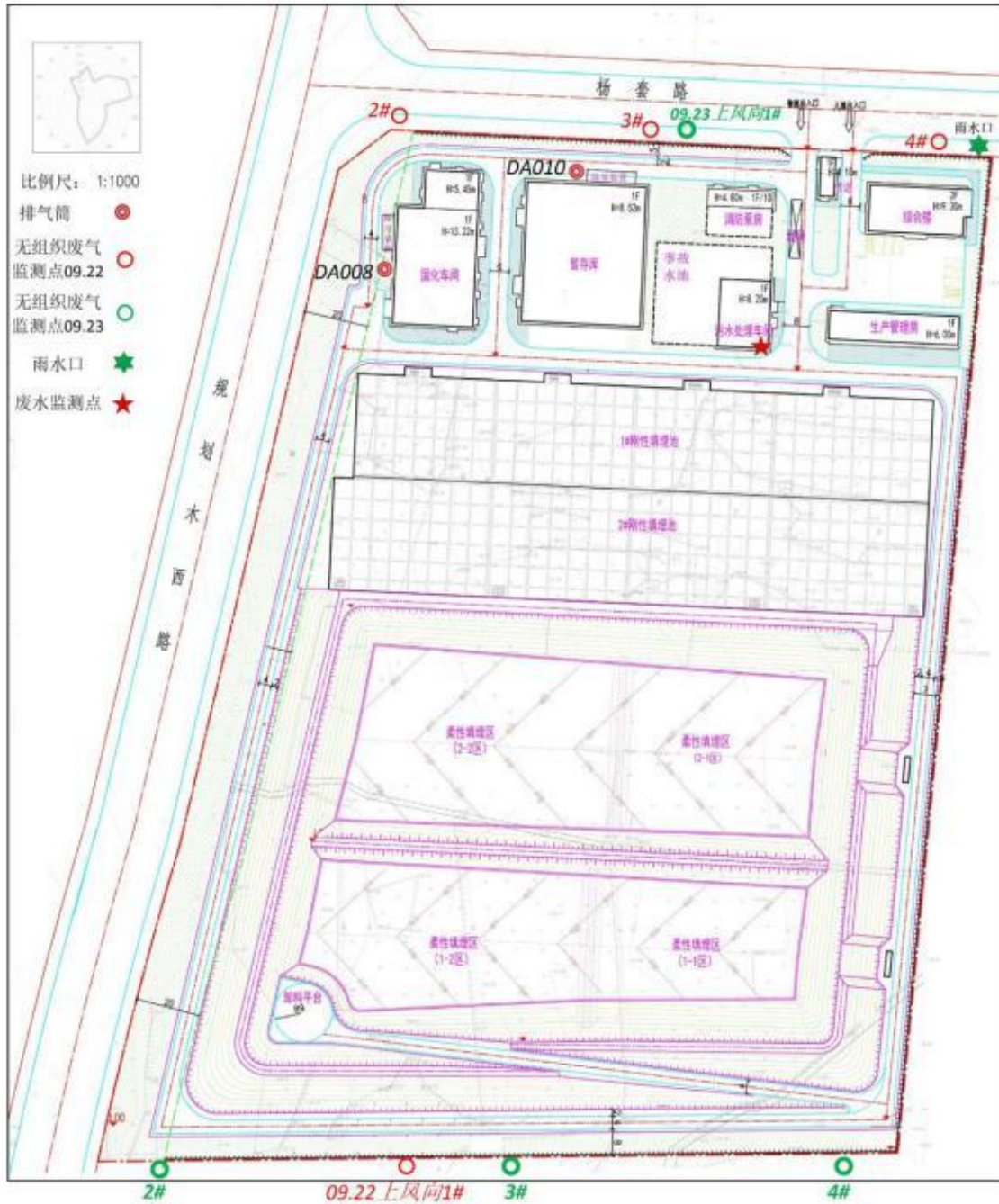
图2.1-14 现有工程废气、废水现状监测布点图
