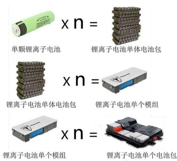
图 2.2-4 锂电池包构成图
