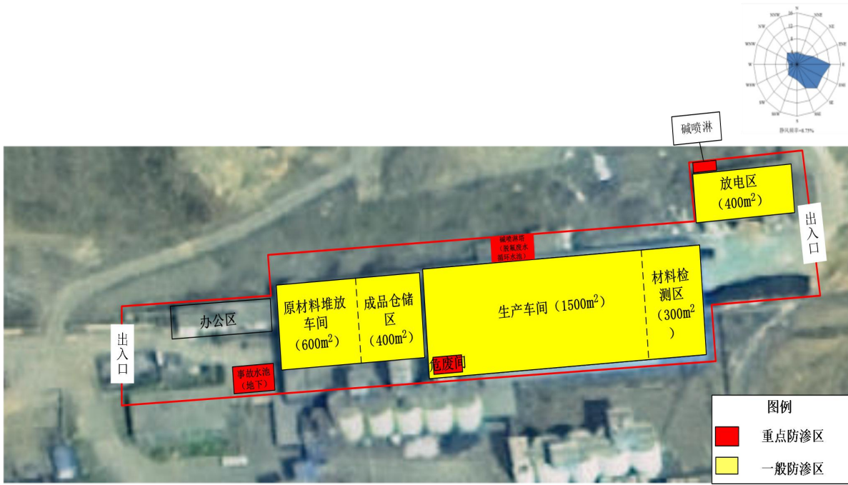
图 4.4-5 拟建项目分区防渗图（比例尺 1:695）
