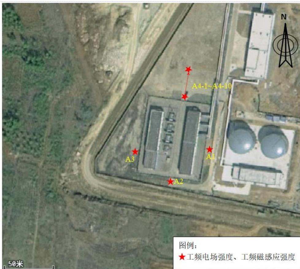
图1 联泓新材料科技股份有限公司110kV变电站类比监测布点示意图
