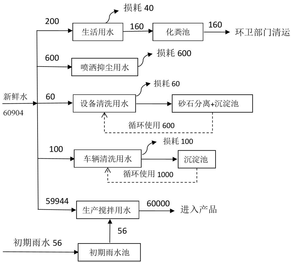
图 2-1 项目水平衡图 (单位: m<sup>3</sup>/a)
