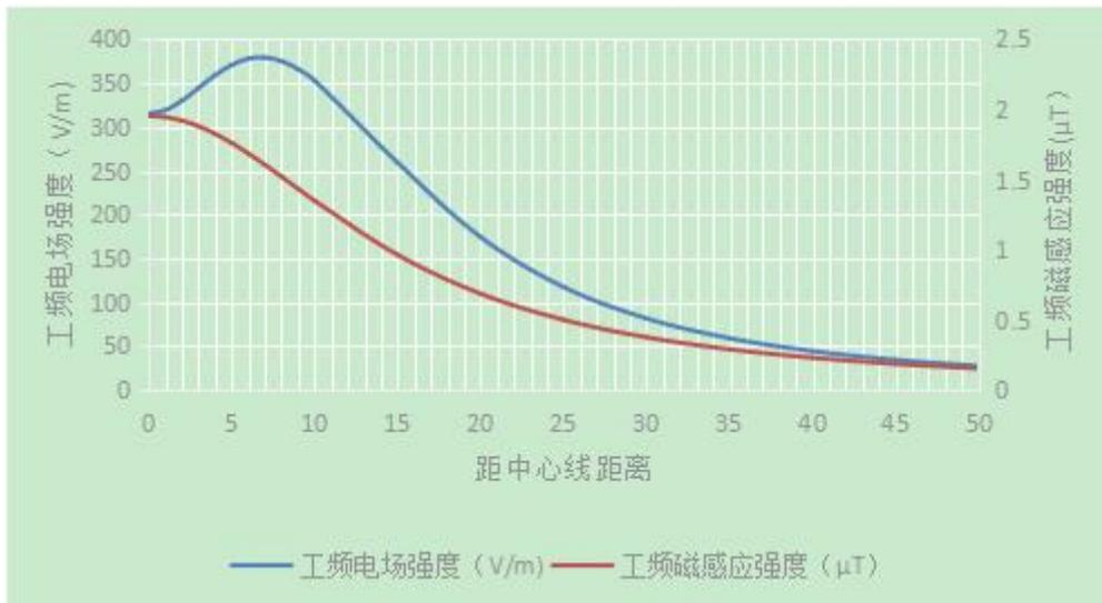
图3 110kV 单回架空线路工频电场强度和工频磁感应强度趋势图
