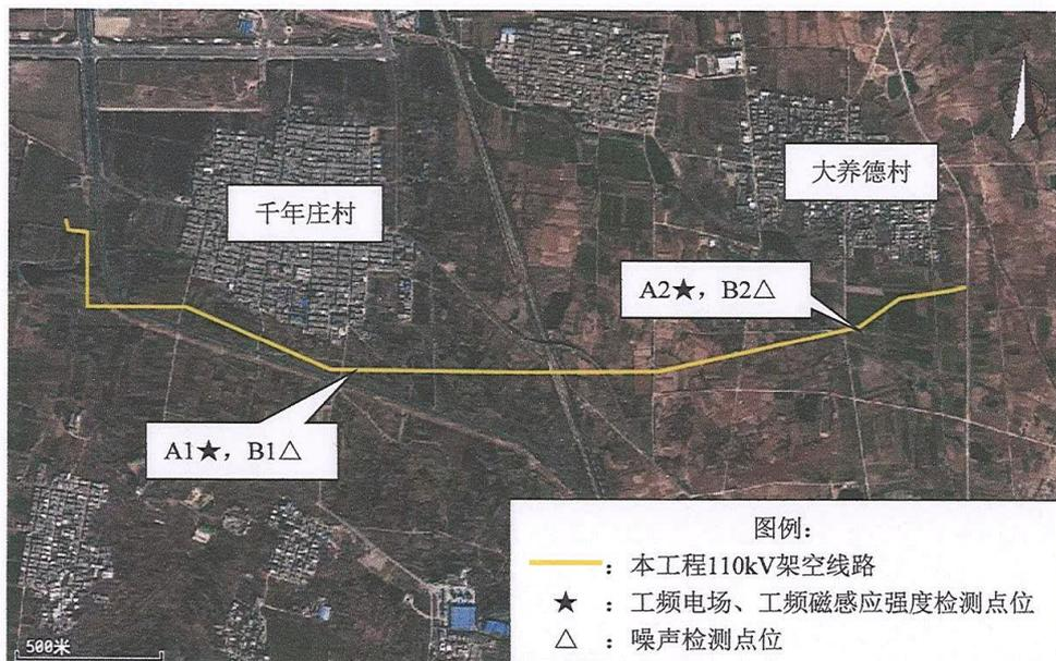
图 1 本工程检测布点示意图
