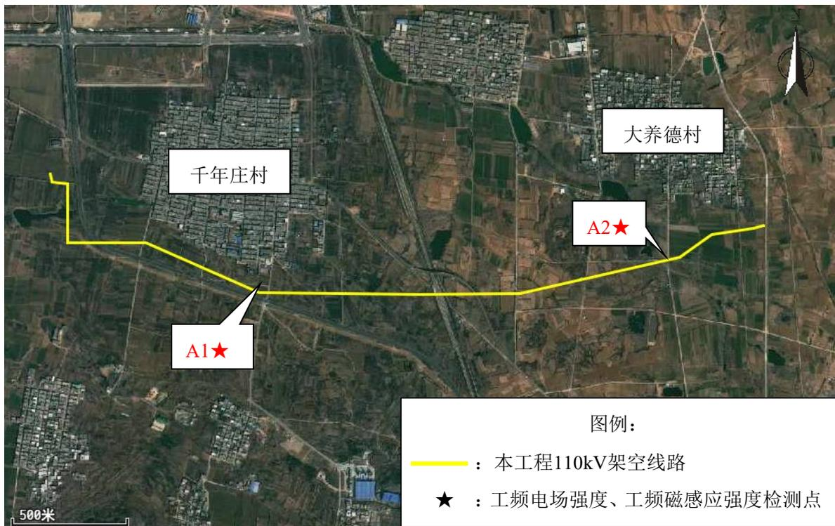
图 1 本工程工频电场强度、工频磁感应强度检测布点示意图
