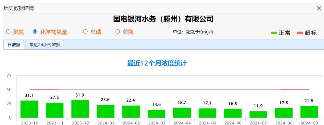
污水处理厂在线监测数据（化学需氧量）
