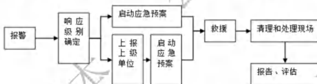
图 6.9-4 企业应急响应流程图
