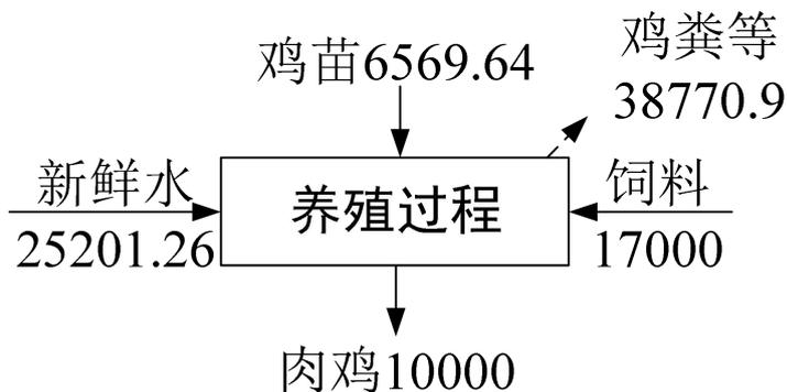
图 2.6-1 拟建项目物料平衡图 (单位: t/a)
