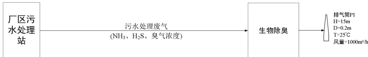
图 2.11-1 拟建项目有组织废气处理措施及走向图
