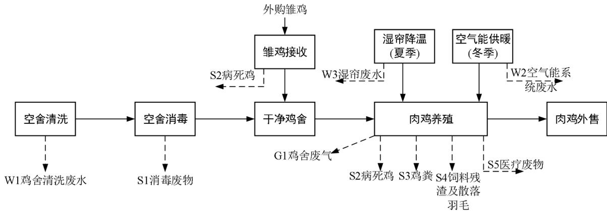
图 2.10-1 工艺流程及产污环节图
