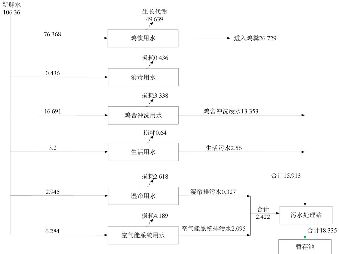
图 2.8-1(4) 拟建项目非灌溉期水平衡图 (单位: m³/d)
