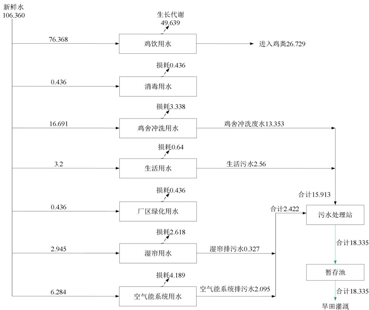
图 2.8-1(2) 拟建项目灌溉期水平衡图 (单位: m³/d)
