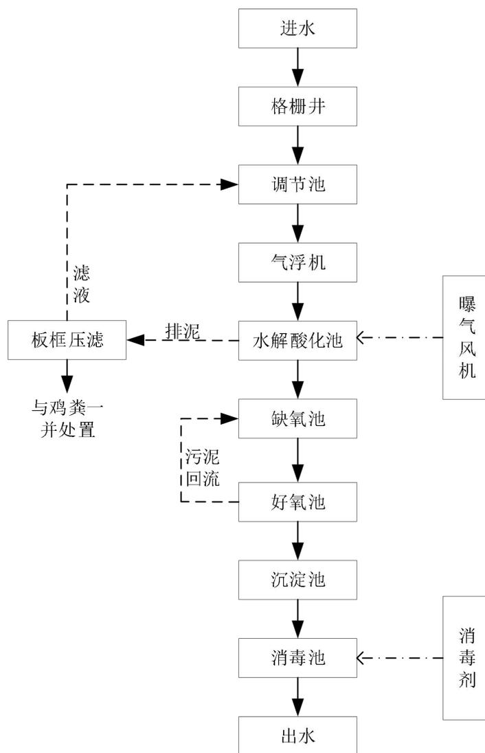
图 2.11-2 污水处理站污水处理工艺流程图
