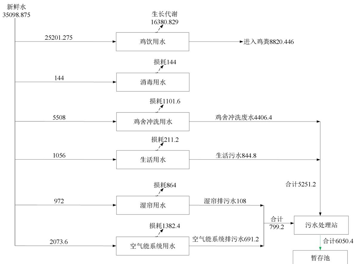
图 2.8-1(3) 拟建项目非灌溉期水平衡图 (单位:  $m^3/a$ )
