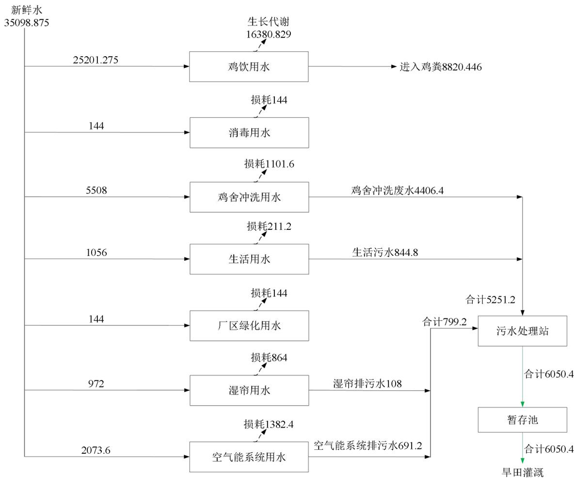
图 2.8-1(1) 拟建项目灌溉期水平衡图 (单位: m<sup>3</sup>/a)
