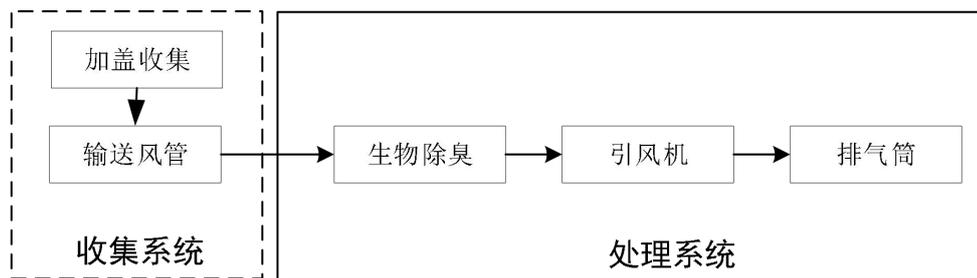
图 5.2-1 除臭工艺流程图
