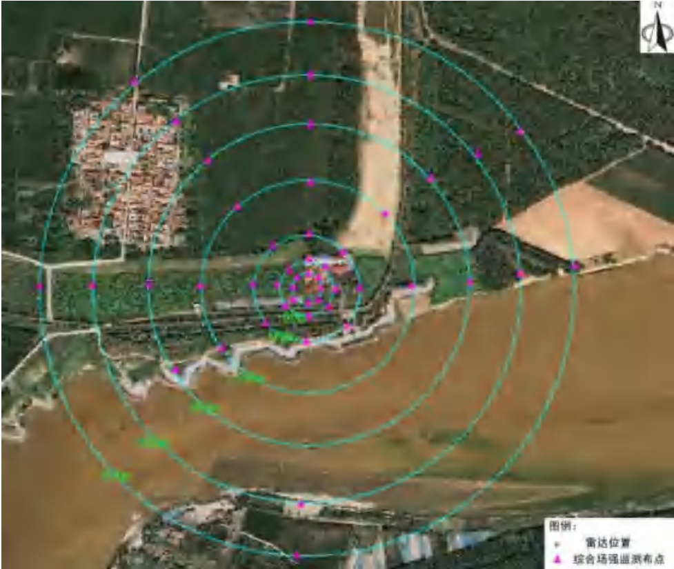
图 5.1-3 雷达 0°-360° 断面监测布点示意图
