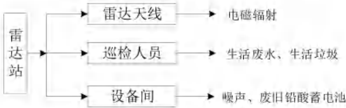
图2.2-9 营运期工艺流程及产污环节示意图
