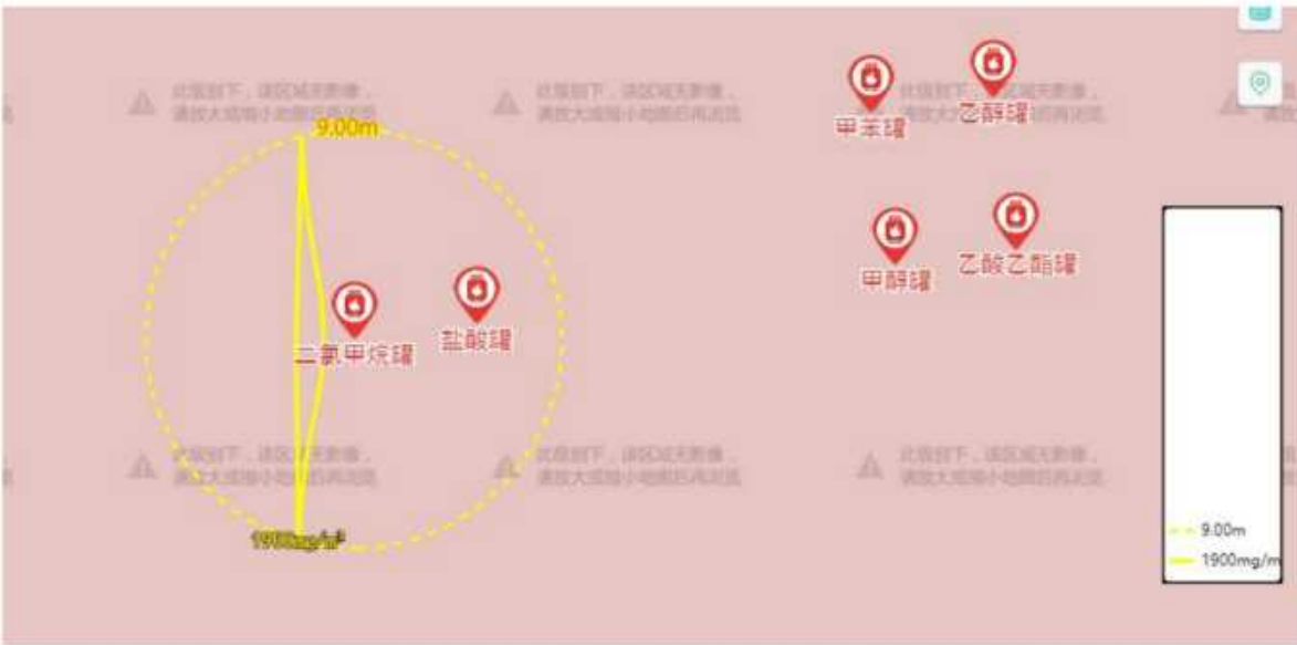
图 5.7-1 最不利气象条件下二氯甲烷泄漏扩散预测最大影响范围图
