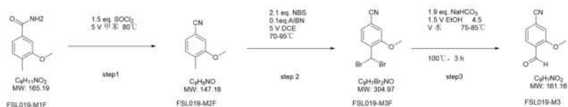
图 2.12-2 FSL019-M3 合成路线图
