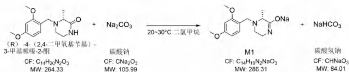
图 2.4-6 M1 合成工序反应式
