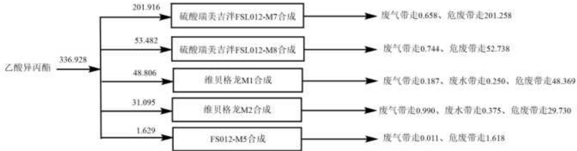
图 2.16-8 乙酸异丙酯溶剂平衡图 (单位: t/a)
