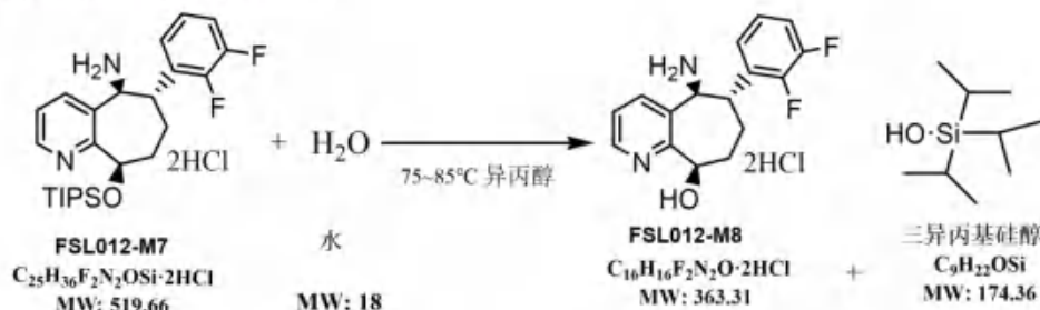
图 2.5-8 脱保护反应式
