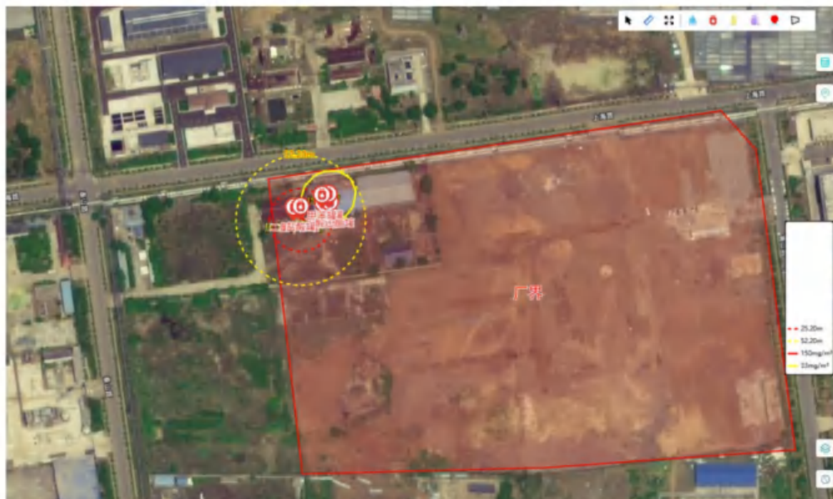
图 5.7-11 最常见气象条件下盐酸泄漏扩散预测最大影响范围图
