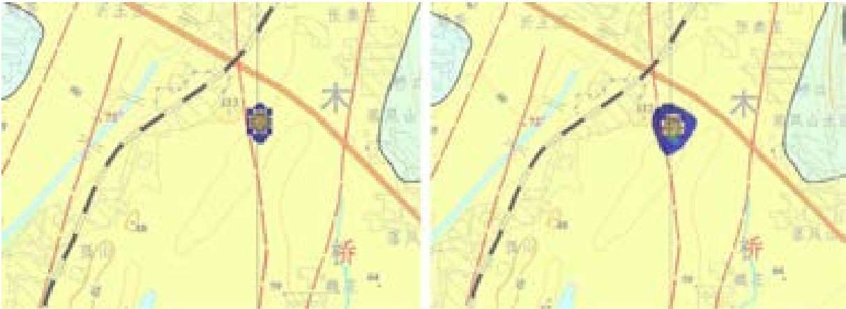
图 4.4-20 工况 3 事故发生 50 天、1980 天后地下水中 NH 3 -N 影响范围图
