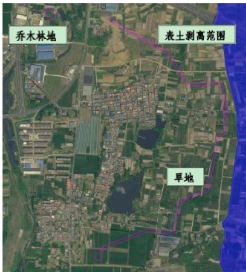
图 5.7-2 表土剥离示意图
