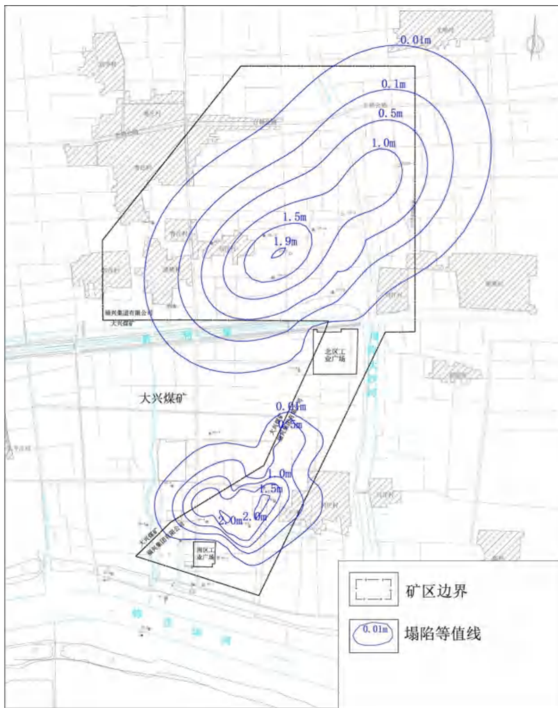
图 5.4-2 本方案服务期内预测塌陷叠加现状损毁后总的地面塌陷图
