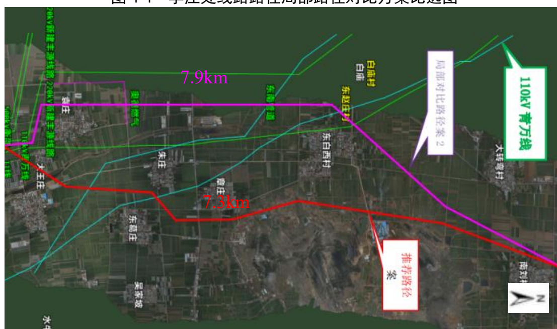
图 4-5 东白西村处线路路径局部路径对比方案比选图
