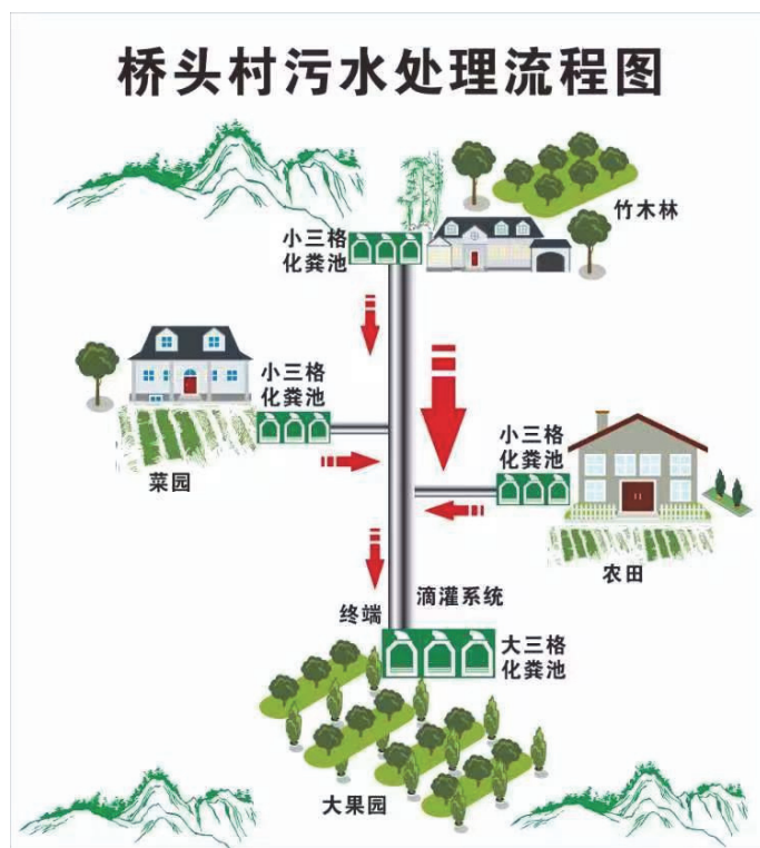
图 3-1 多级发酵系统工艺流程图
