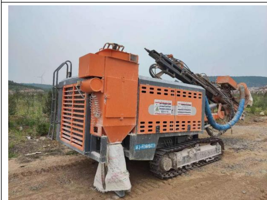
矿山钻孔机配备除尘器
