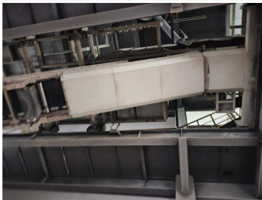
水泥袋装封闭装车通道
