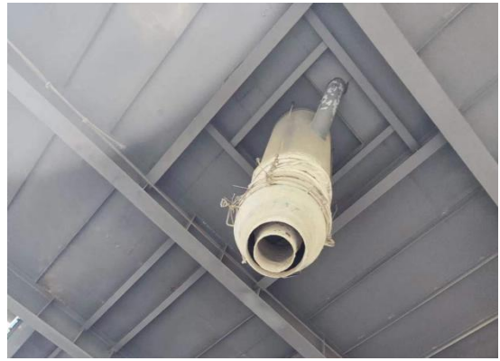
带抽风口的散装下料器
