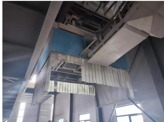
水泥袋装封闭装车通道
