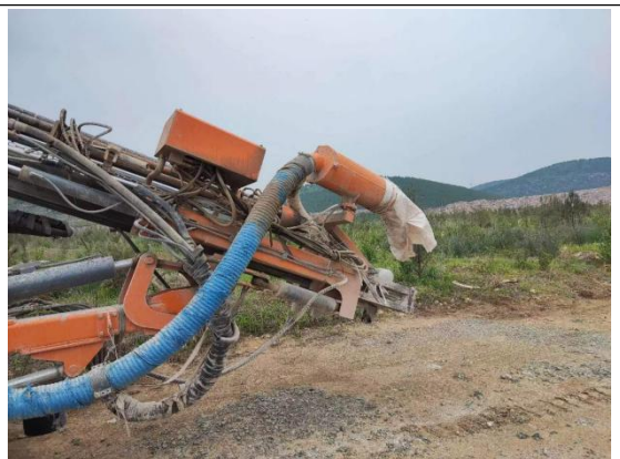
矿山钻孔机配备除尘器
