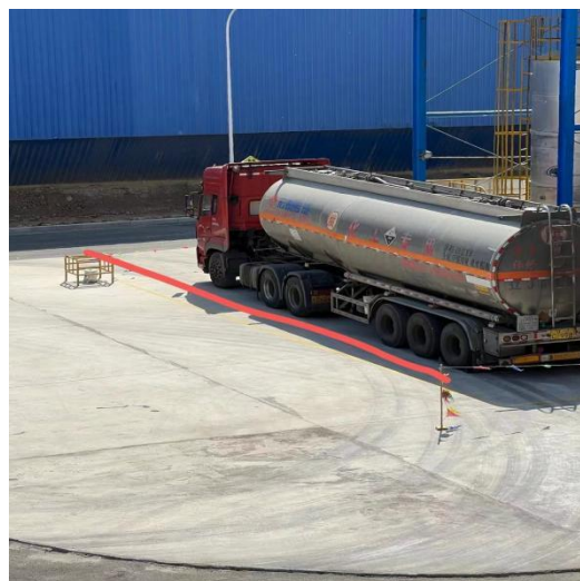
氨密闭罐车运输
